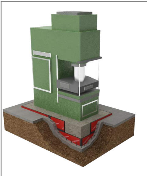
MASCHINENISOLIERUNG AUF SCHWIMMENDEM FUNDAMENT
