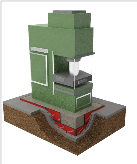
MASCHINENISOLIERUNG AUF SCHWIMMENDEM FUNDAMENT
